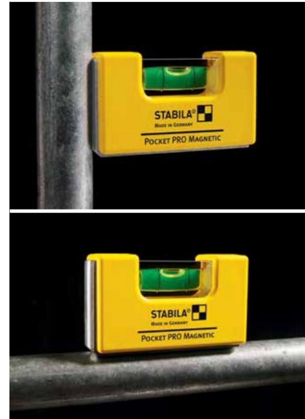
**Pocket PRO Magnetic:** 专业的袖珍型水平仪，采用坚固的矩形铝心外壳，两个精研磨测量面带 V 型槽，用于水平和垂直测量。底面和侧面测量面上有强力稀土磁铁。特别适合金属结构施工中的作业。一款适用于所有工匠的两用测量工具。
