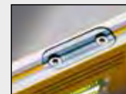
Tüüp 81 SV REM W45: Eriti tugev nakkumine torude ja muude terasdetailidega tänu V-soonega freesitud mõõtepinnale ja haruldastest muldmetallidest magnetitele.
