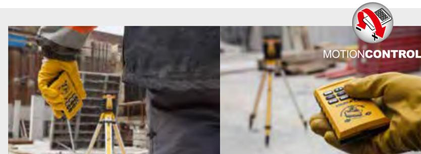
**MOTION CONTROL:** интуитивный пульт дистанционного управления со встроенным датчиком движения. При наклоне пульта вправо или влево датчик движения ускоряет или замедляет выбранную функцию лазера. Таким образом можно легко управлять разнообразными функциями прибора и выполнять настройки на расстоянии до 20 м.
