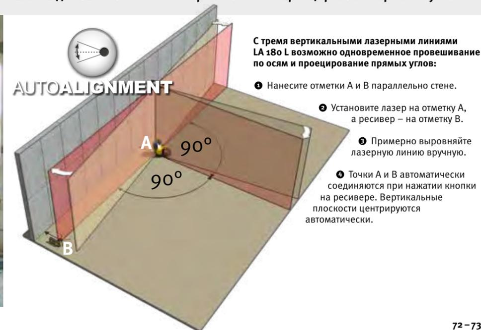
С тремя вертикальными лазерными линиями LA 180 L возможно одновременное провешивание по осям и проецирование прямых углов:
