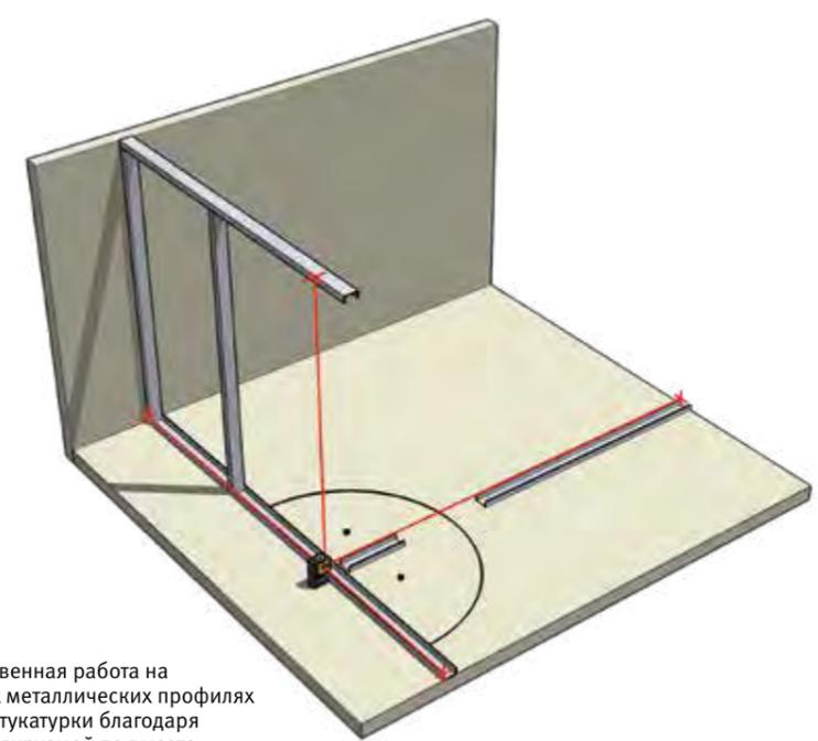
Непосредственная работа на U-образных металлических профилях для сухой штукатурки благодаря ножке, регулируемой по высоте.
