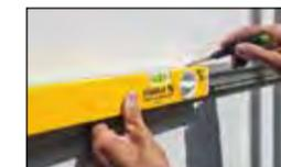
Сплошная грань по всей длине уровня: измерение и нанесение разметки за одну рабочую операцию, в том числе в выдвинутом состоянии.
