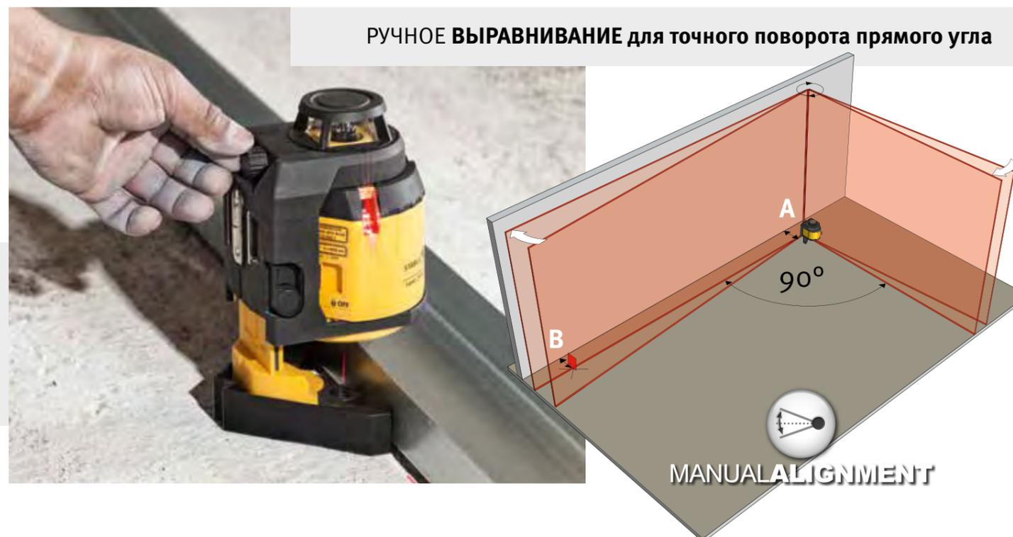
С помощью двух вертикальных лазерных линий прибора LAX 400, образующих прямой угол, можно делать разметку прямых углов в помещениях.
