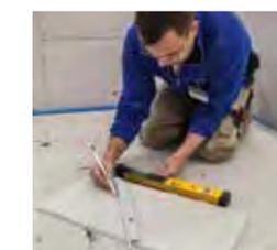
**TECH 700 DA:** Особенно подходит для столярных работ. Позволяет определять и переносить параметры углов, например при монтаже кухонной мебели или выравнивании другой встраиваемой мебели. Идеальный помощник при укладке сложных рисунков на плитке – для переноса размеров углов при резке плитки. Идеальный партнер в деревянном строительстве – для снятия углов при подготовке к косой распиловке.
