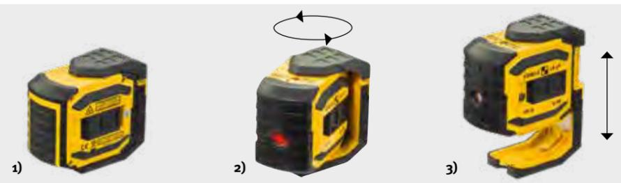
1) Положение для транспортировки. 2) Подвижную часть прибора можно поворачивать внутри корпуса на 360°. 3) Благодаря регулируемой по высоте ножке можно изменять высоту лазерной линии.
