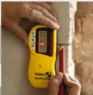
**Utilisation souple du récepteur :** vous pouvez positionner le REC 210 Line\* directement sur la cible à la main ou le fixer sur la latte de nivellement NL STABILA (accessoires en option N° art. 07468/5).
