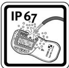
Coperchio del vano batterie: a tenuta d'acqua, la resistenza all'acqua e alla polvere è data dalla pressione del coperchio contro la guarnizione. IP 67
