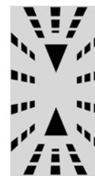
Occorre prima spegnere il ricevitore! Premere contemporaneamente i tasti ON/OFF (tasto 1) e "precisione" (tasto 3), per accendere lo strumento nella modalità industriale. A conferma dell'avvenuta accensione, il ricevitore emette un singolo bip. Il simbolo "precisione" (c) sul display lampeggia.
