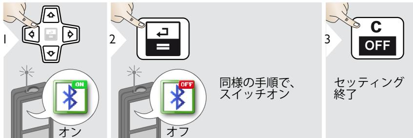
**i** デフォルトモード：Bluetooth® スイッチオン。Bluetooth® 接続が完了すると、Bluetooth® アイコンが、ステータスラインに表示されます。
