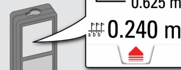
1 ステイクアウト点は 0.1m の下に行く時、測定器はビープ音を開始します。ステイクアウトは、CEAR/OFF キー押下で終了します。
