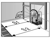
Para medir ângulos de azulejos, lambris, parquetes (chão, tecto, parede) simplesmente através do basculamento.
