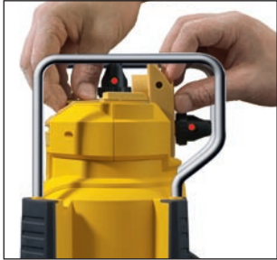
Commutation de la position horizontale à la position verticale.
