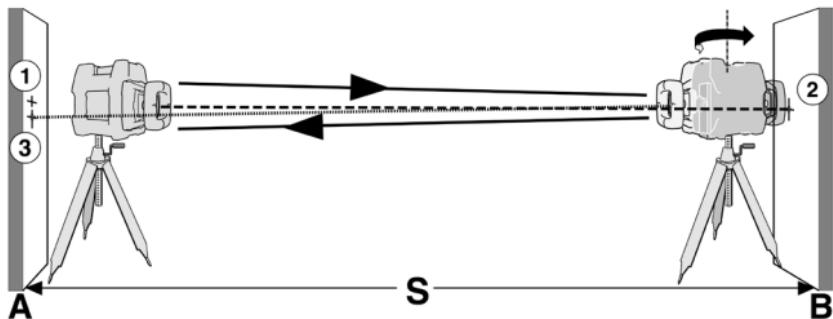
进行垂直检验需要两个相距至少 10 m 的平行墙面 .
