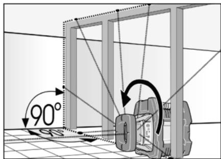
调节瓷砖地板, 护壁板, 镶木地板(地板, 天花板, 墙壁), 通过转动来调节直到形成直角。
