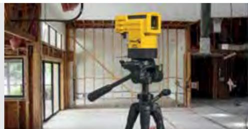
**Con attacco filettato treppiede fotografico da 1/4":** piattaforma multiuso girevole per un posizionamento flessibile del laser.
