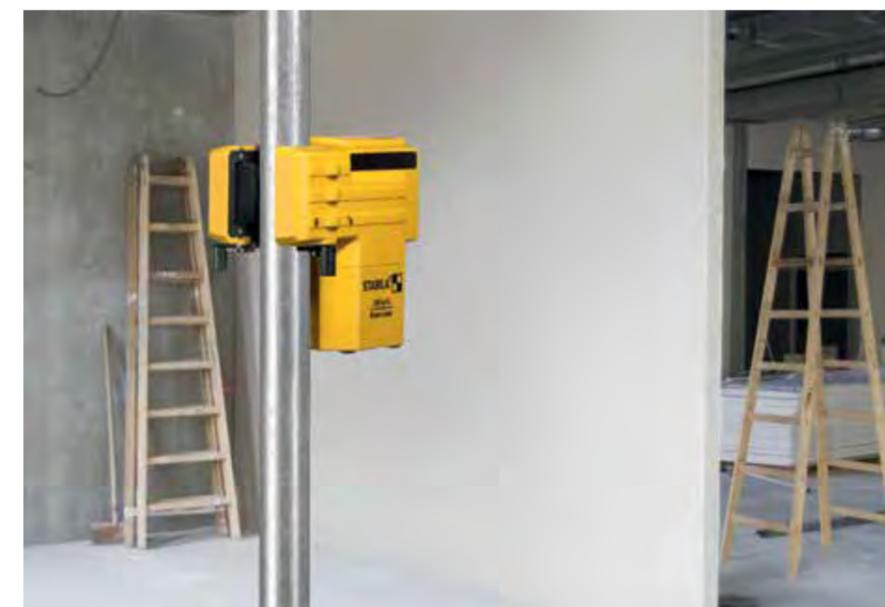
**Per il fissaggio su tubi:** dispositivo di bloccaggio integrato.
